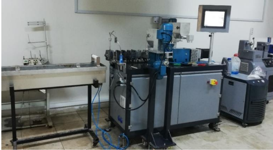
Şekil 2.3: Üretim yapılan çift vidalı ekstrüder
